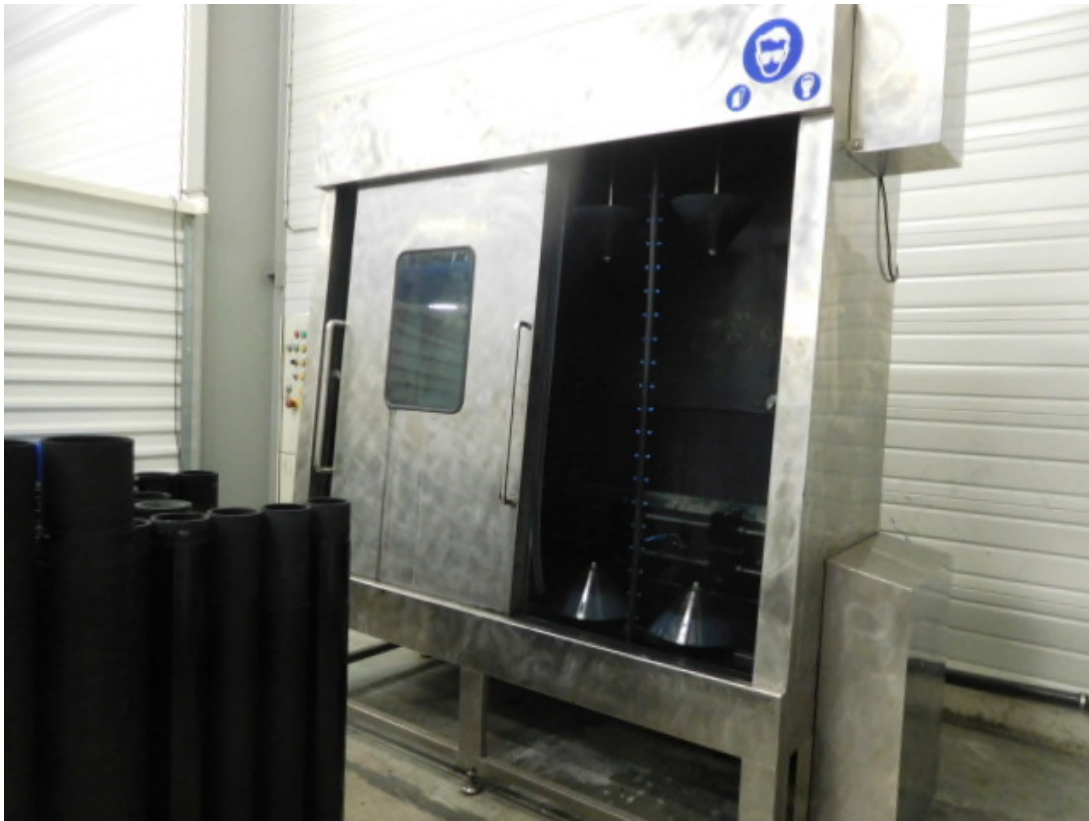
Equipement de nettoyage des manchons
